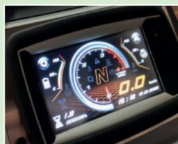
Display elettronico di ultima generazione con spie anomalie, luci, motore, livelli olio idraulico e livello di carica.
