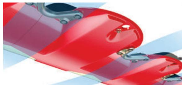
Profilo aerodinamico della barra falciante (lato inferiore)
