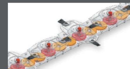
Barra falciante con ingranaggi in bagno d'olio
