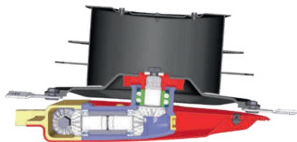
Sezione trasversale della barra falciante
