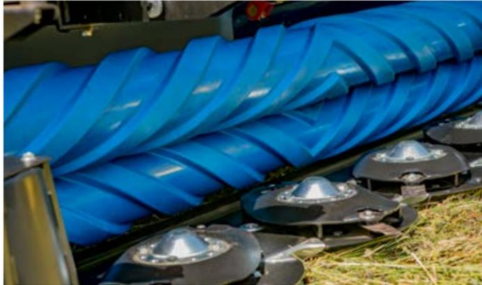
La **pressione di condizionamento** è regolabile mediante un comando a leva collegato a barre di torsione che registrano la distanza tra i rulli da 0 a 40 mm. In quest'ultima posizione il foraggio falciato passa tra i rulli senza essere condizionato.
