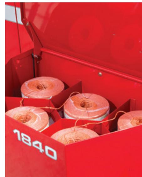
Il modello MF 1840 è in grado di contenere 10 rotoli di spago, sufficienti per le giornate di lavoro più lunghe. Le grandi dimensioni di ogni scomparto consentono di utilizzare bobine di spago "super-grandi", permettendo il trasporto di ancor più spago e, di conseguenza, di produrre più balle per singola ricarica.
