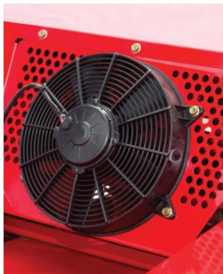
La pressa MF 1840 è dotata di serie di una ventola elettrica che mantiene i legatori puliti e liberi da accumuli di detriti durante il funzionamento.
