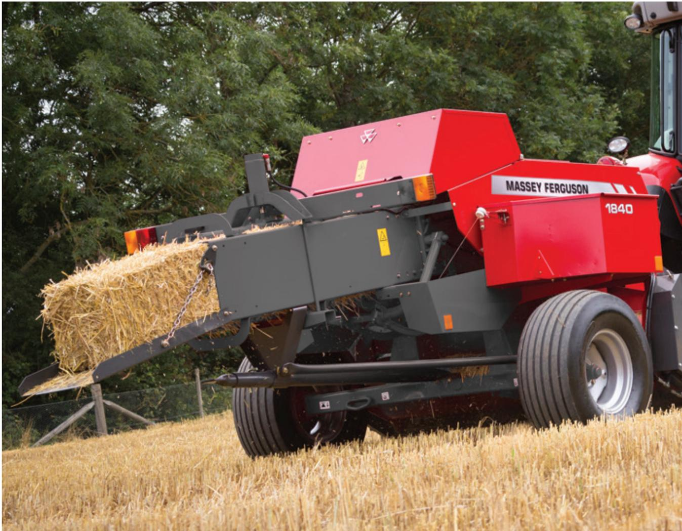
Per garantire una forma eccellente e una densità costante in tutte le condizioni, la camera di compressione OptiForm è di 460 mm (il 30%) più lunga rispetto alla camera del modello precedente MF 1839.
